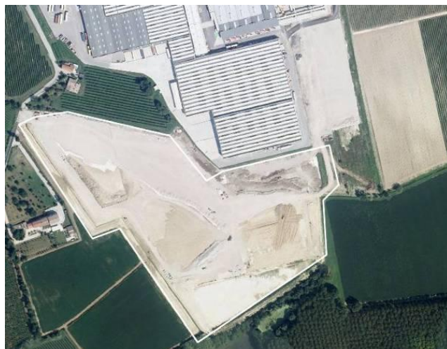
N. 11: Ampliamento a Mansuè (TV) di una ditta di lavorazione del legno di Portobuffolè che lavora per un colosso dell'arredo (immagine 2017 a sinistra e 2018 a destra); il cantiere è di 131.900 m 2 , con 31.700 m 2 di edifici e un totale impermeabilizzato, ad ora, di 60.000m 2 .
