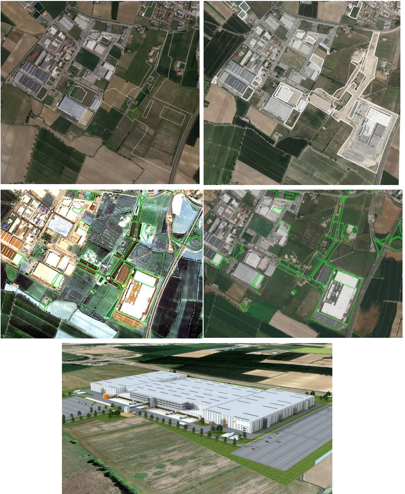
N 1: Magazzino di un colosso dell'e-commerce tedesco a Nogarole Rocca (VR); 150.600 m 2 di magazzino, 31 ha di area impermeabilizzata comprensiva della nuova viabilità, piazzali e parcheggi, 33 ha di superficie complessiva del cantiere. (immagine del 2017 in alto a sinistra, del 2018 in alto a destra, immagine Gaofen 2019 in centro a sinistra, immagine Google Earth 2020 in centro a destra; rendering in basso).
