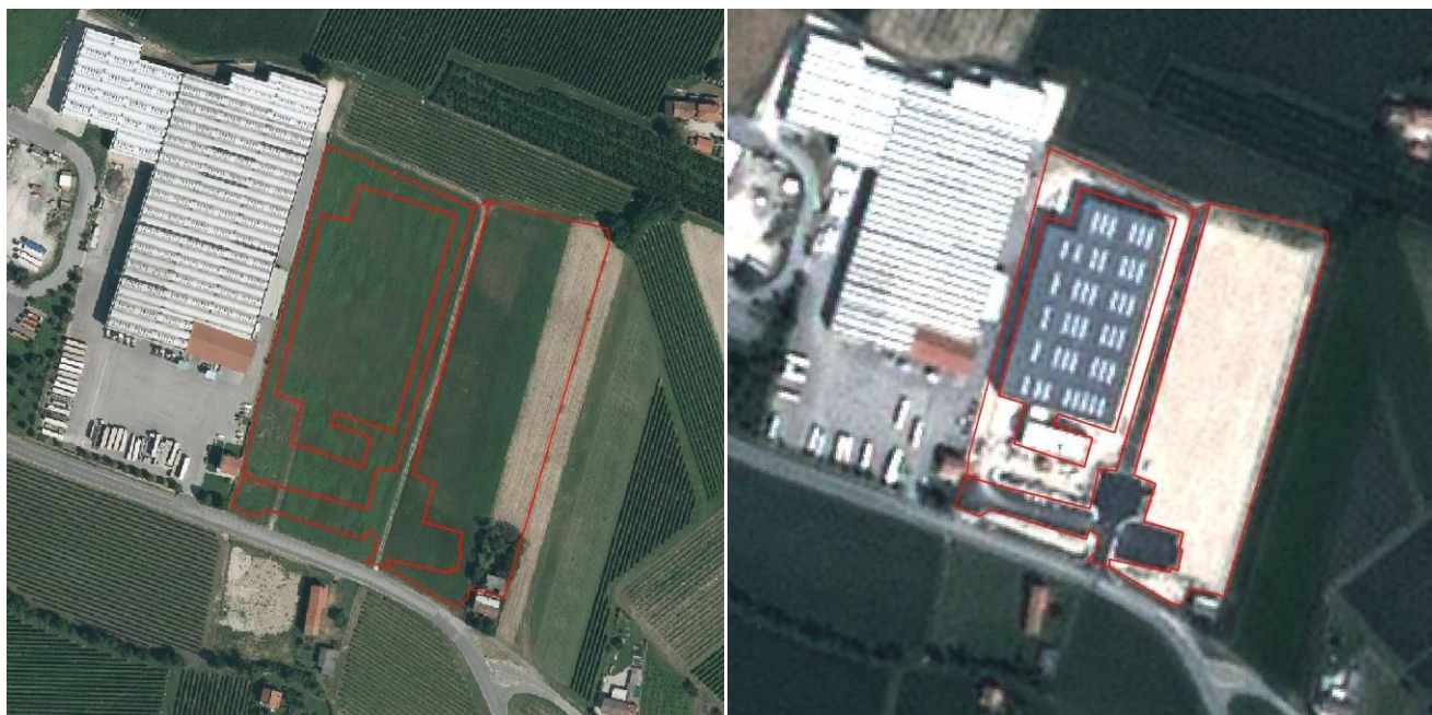
N. 16: Centro logistico a Cimadolmo (TV) di nuova realizzazione con un cantiere di 38.300 m 2 , di cui 10.600 m 2 consumati per la realizzazione di un magazzino e 12.100 m 2 occupati da aree impermeabilizzate per piazzali, parcheggi e viabilità (immagine 2018 a sinistra, 2020 a destra).
