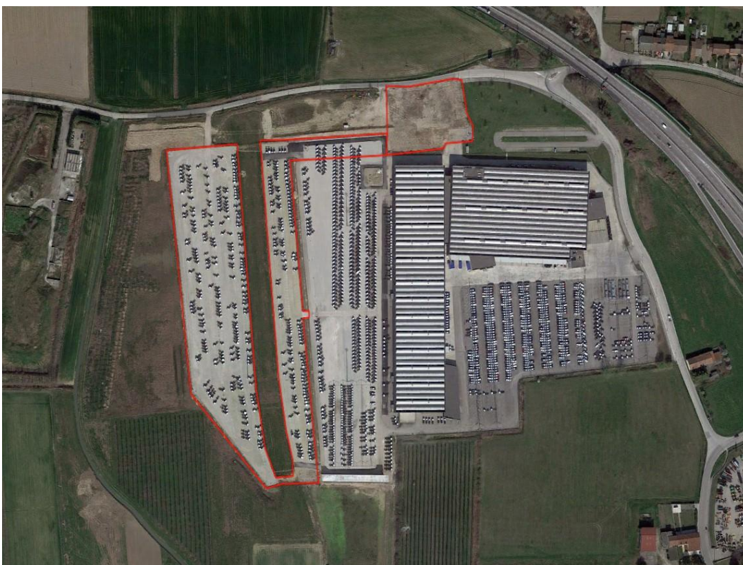
N. 20: Ampliamento di un insediamento industriale esistente adibito alla fabbricazione di autoveicoli a Legnago (VR). L'ampliamento realizzato tra il 2019 ed il 2020 riguarda una superficie complessiva di circa 3,6 ettari, dei quali 32.100 m 2 occupati dalle nuove aree impermeabilizzate adibite alla rimessa dei mezzi (immagine 2018 in alto, immagine Triplesat 2020 in basso).
