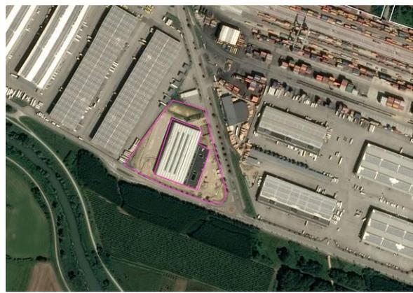
*Fig. 38: Nuove costruzioni nell'area industriale di Padova Est: parcheggio di circa 10.000 m<sup>2</sup> (in alto) e nuovo edificio industriale di 11.300 m<sup>2</sup> su un'area di 28.300 m<sup>2</sup> di cantiere (in basso); nelle immagini si può vedere come le opere siano state realizzate nell'arco di un anno (immagini 2018 a sinistra e 2019 a destra).*
