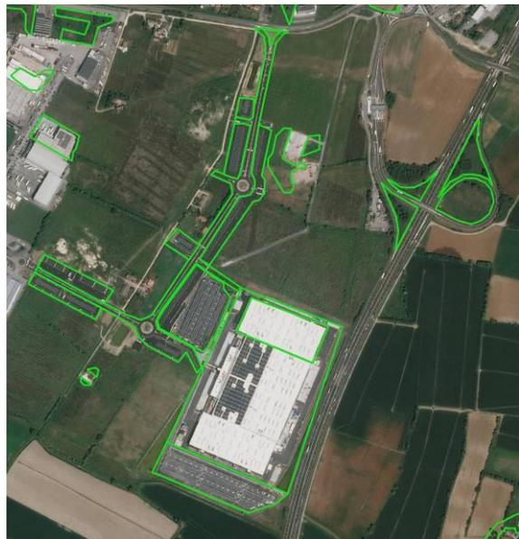
*Fig. 39: Magazzino di un colosso dell'e-commerce tedesco a Nogarole Rocca – VR; 150.000m<sup>2</sup> di magazzino, 20 ha area impermeabilizzata e 40 ha di superficie complessiva del cantiere; da area agricola nel 2017 (immagine a sinistra), a opera finita con magazzino, parcheggi e viabilità connessa (immagine 2019 a destra).*
